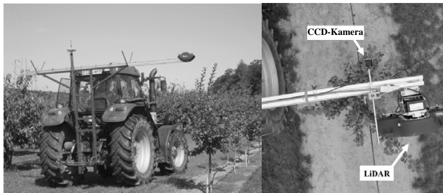
Abbildung 1: Traktor mit Ausleger und LiDAR (links), Draufsicht auf die Messsysteme (rechts)
