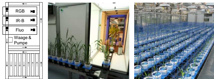
Abbildung 1: Automatisiertes Aufnahmesystem für Gerste; Anlagenüberblick (links); Beladestation und Bildaufnahmekammern (Mitte); Gewächshausbereich (rechts)
