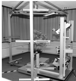
Abbildung 2: Realisiertes Messsystem für Tabak-Pflanzen
