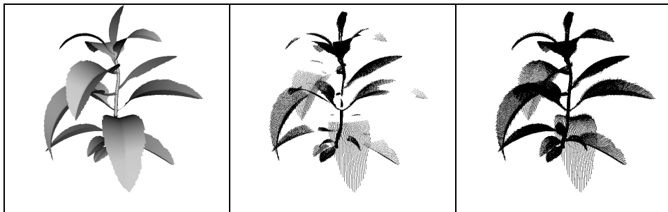
Abbildung 1: Pflanzenmodell (links). Simulationsergebnis mit einer (Mitte) und drei (rechts) Laser-Kamera-Paaren: Dargestellt sind die erfassten Bereiche der Pflanze.
