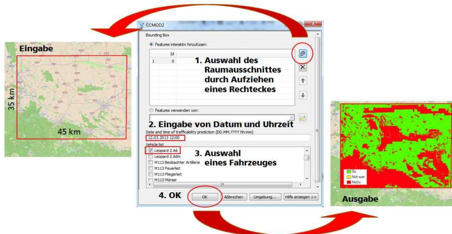
Abbildung 2: Einfach konzipierte Mensch-Maschine-Schnittstelle für den Endanwender
