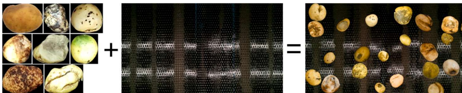
Abb. 4: Generierung semi-synthetischer Trainingsdaten zur Lokalisierung von Kartoffeln
