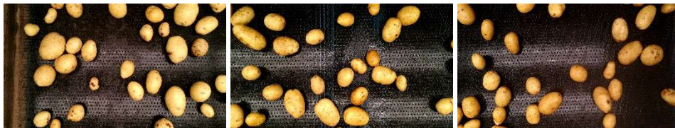
Abb. 3: Aufnahmen der drei Kameras vom Vereinzelungsband mit Kartoffeln
