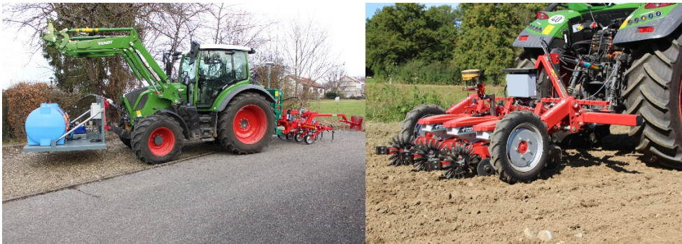
Abb. 1: Links ist der aktuelle Stand des Prototyps, rechts ist die Sämaschine mit dem aufgebauten GNSS-Empfänger zu sehen
